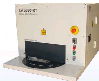
LWS080-RT: Desktop-Laserzelle mit Rundscharltisch - klein, kompakt, effektiv
